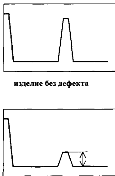
Рис. 3.41. Вид экрана дефектоскопа при контроле теневым методом
