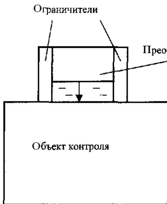
Рис. 3.54. Щелевой контакт протектором
